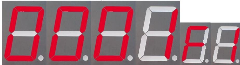
**0002F1** режим работы ТРК по протоколу Shelf 485, управление ТРК производится системой управления (на системе управления набрать необходимое количество литров и снять кран топливораздаточный с ТРК, через 4 секунды включится насос ТРК).
