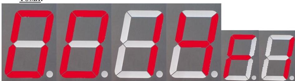
**1004F1** режим работы ТРК с пульта «Сапсан или другого пульта в импульсном режиме» без подтверждения красной кнопки и установкой крана топливораздаточного в лоток после каждой дозы выдачи топлива, выдача импульсов на пульт в литровой дозе, один импульс равен 1л.
