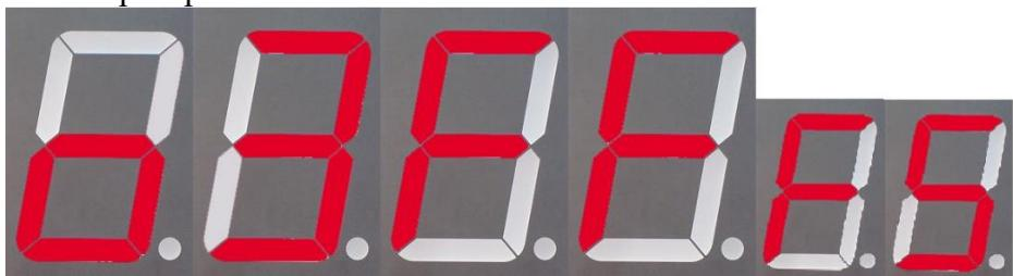
**F6** Шестой пункт меню, таймаут от пуска двигателя до первого импульса датчика импульсов. Значения от 1 до 180 секунд,
