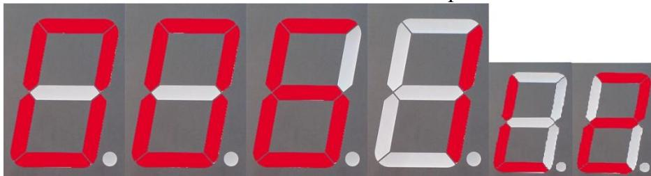
**F3** режим изменения сетевого адреса крана топливораздаточного ТРК (необходим при работе с системой управления по протоколу SHELF 485). Значения сетевого адреса могут быть только кратные 5, начиная с 10 - го, то есть 10, 15, 20, 25, 30 и т.д.
