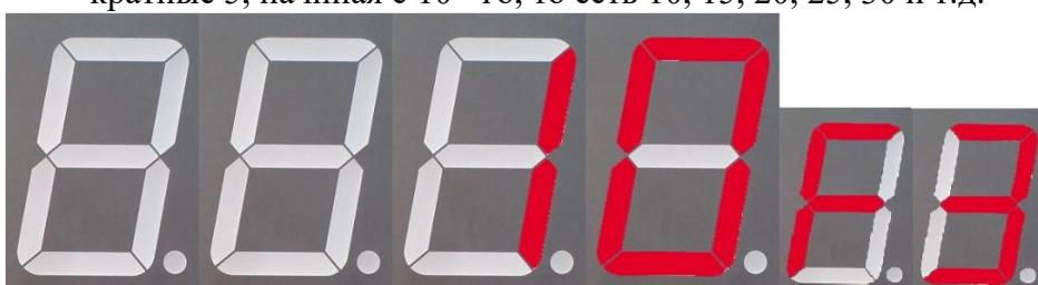
Цифра 10 на табло означает сетевой адрес крана топливораздаточного ТРК. Для выбора другого адреса необходимо нажать клавишу «→», убрать цифры, и клавишами 0..9 на клавиатуре ТРК поставить нужные цифры, чтобы подтвердить изменение сетевого адреса необходимо два раза нажать клавишу "#". При нажатии на клавишу «0» высветится подменю P3.
