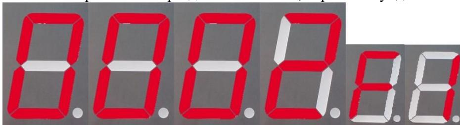
**0013F1** режим работы ТРК с пульта «Сапсан или другого пульта в импульсном режиме» и с подтверждением красной кнопки, выдача импульсов на пульт в милилитровой дозе, один импульс равен 10мл.
