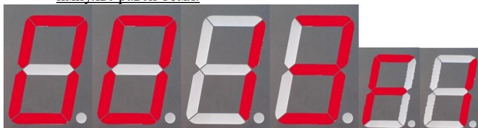
**1003F1** режим работы ТРК с пульта «Сапсан или другого пульта в импульсном режиме» и с подтверждением красной кнопки, выдача импульсов на пульт в литровой дозе, один импульс равен 1л.
