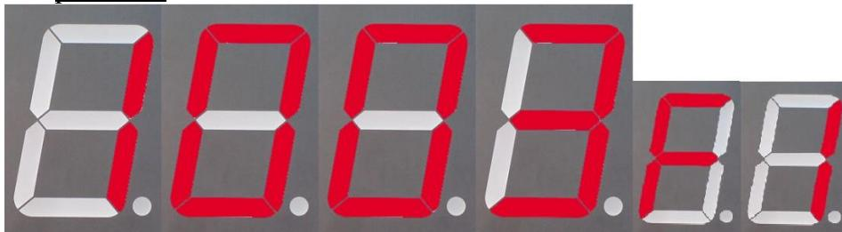
**0014F1** режим работы ТРК с пульта «Сапсан или другого пульта в импульсном режиме» без подтверждения красной кнопки и установкой крана топливораздаточного в лоток после каждой дозы выдачи топлива, выдача импульсов на пульт в миллилитровой дозе, один импульс равен 10мл.
