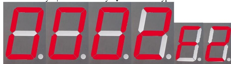
Где 0002 - число сделанных калибровок, а F2 - режим меню. Для электронной корректировки дозы налива ТРК необходимо снять кран топливораздаточный с ТРК, вставить
